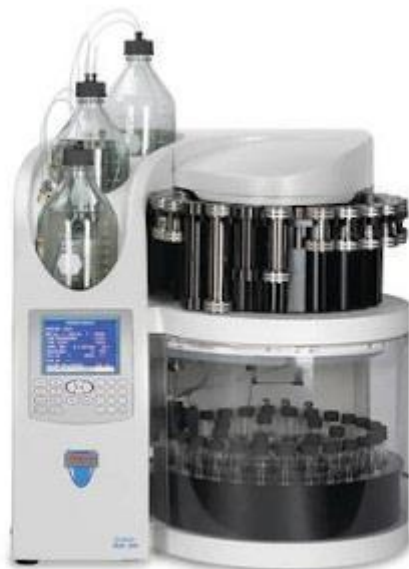
Figura 1. Extrator Acelerado por Solvente - Dionex ASE 350.
